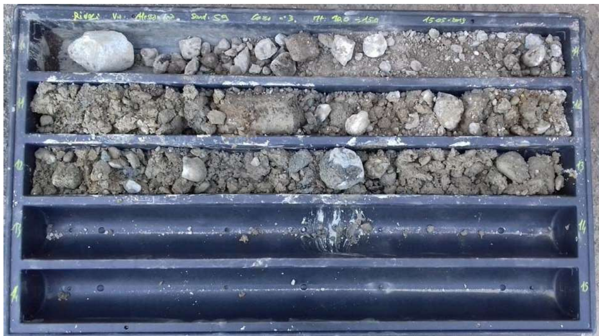
Fig. A 3.6. Sondaggio S9. Cassetta catalogatrice. Profondità 10 – 13 m.
