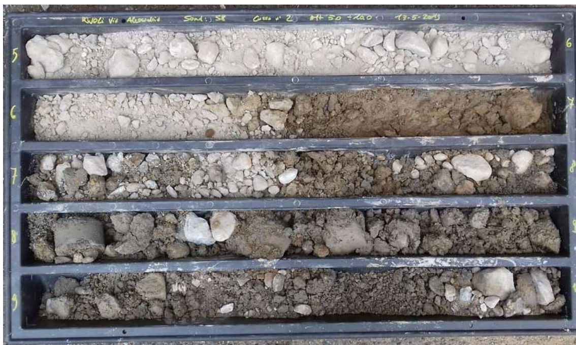
Fig. A 3.2. Sondaggio S8. Cassetta catalogatrice. Profondità 5 – 10 m.
